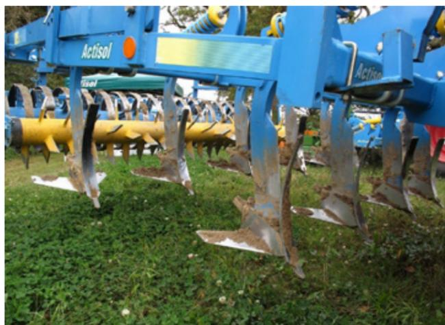
Photo 1 : l'outil Demeter en version déchaumage avec ses 9 dents équipées d'ailettes. À l'arrière le rouleau mixteur (en jaune) puis le rouleau Flex.
