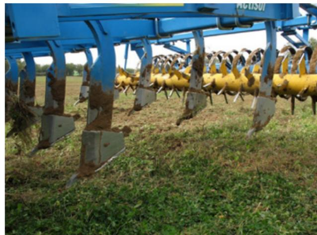
Photo 2 : le Demeter en mode décompacteur (sabots de fissuration). Il permet un travail de fissuration à 40 cm de profondeur sans bouleverser la vie du sol, avec une bonne pénétration même en terrains relativement compactés.
